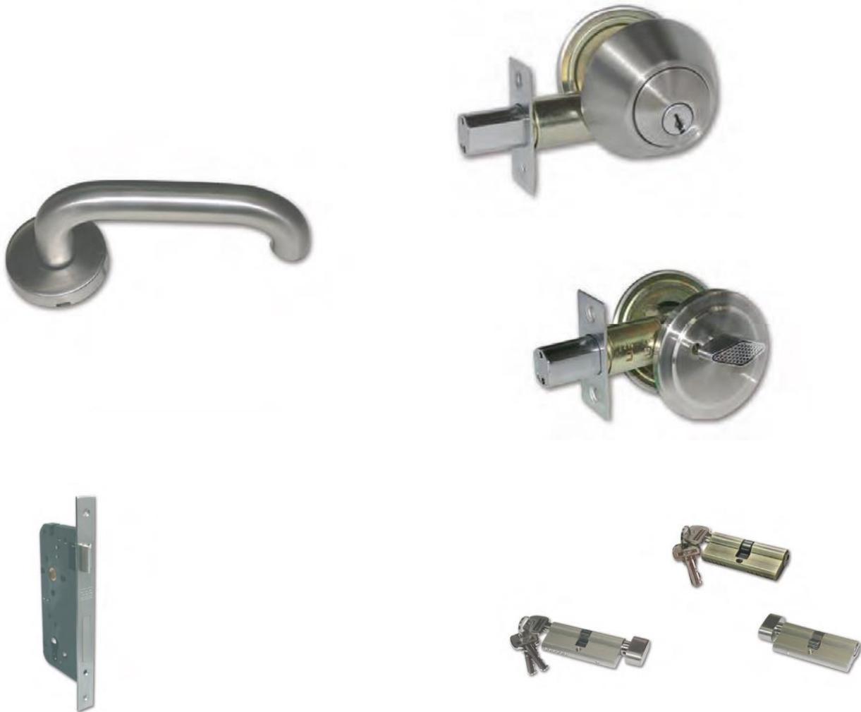
**8.2.- CERRADURA SEGURIDAD** \_1074 AL CIL/MAR. Cerradura de embutir backset de 40mm seguro interior/cilindro exterior cerrojo de dos pitones una vuelta de llave, Acabado inox satin. Marca SCN.
